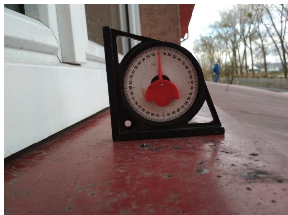
obr. /34/ Ochranný nátěr svodu je zdegradovaný obr. /35/ Spád oplechování je v některých částech objektu pouze 1^\circ
